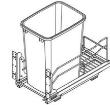
1) Instale el carter en las guías como en la imagen. Asegúrese de colocar bien la parte trasera de la corredera bajo la lengüeta metálica antes de enroscar el tornillo de cabeza Phillips en la parte delantera de la guía deslizante. Asegurese de que los pies de la guia apunten hacia adentro, como se muestra.
