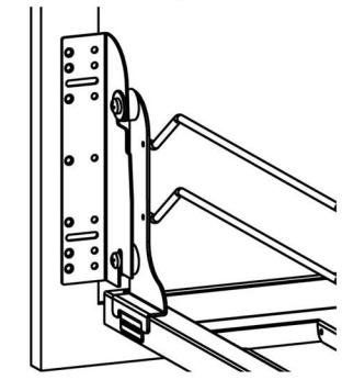
5) Aplique cinta de doble lado a los soportes de la puerta. Sujete la puerta del gabinete a los soportes mientras trata de mantener la puerta a nivel. No se preocupe si la puerta se mueve un poco, esto puede ser ajustado. La cinta de doble lado sujetara la puerta en su lugar mientras usted atornilla los soportes a la puerta del gabinete.
