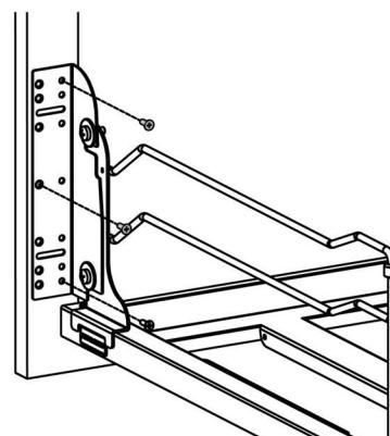
7) Ahora que la puerta del gabinete està sujetada, usted podrà ajustar la puerta completamente, aflojando y posicionando los pernos. Una vez que la puerta esté alineada correctamente, usted puede volver apretar los cuatro pernos.
