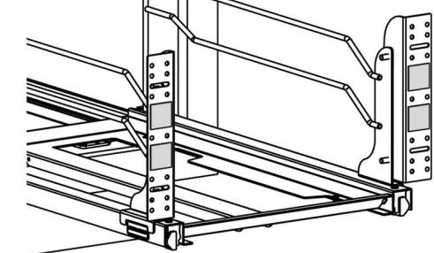
6) Utilizzando los tornillos de madera que se proveen, asegure los soportes a la puerta del gabinete.
