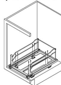
4a) Sujete los soportes de la puerta a la parte exterior de los soportes tipo L, utilizando los cuatro tornillos que se proveen.
