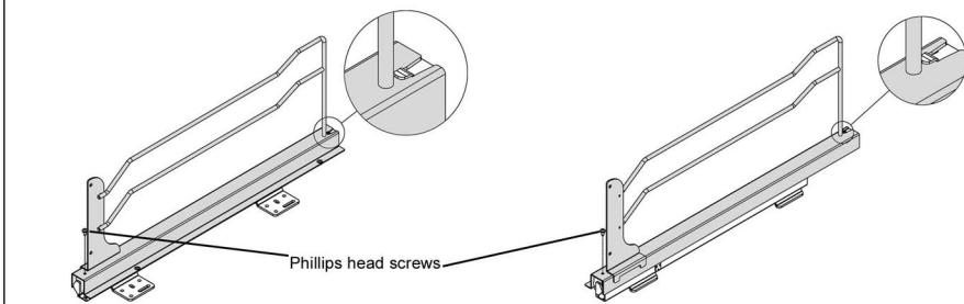
2) Instale el chasis principal de las guías, como ilustrada, utilizando los 4 tornillos previstos e instalar el travesano.
